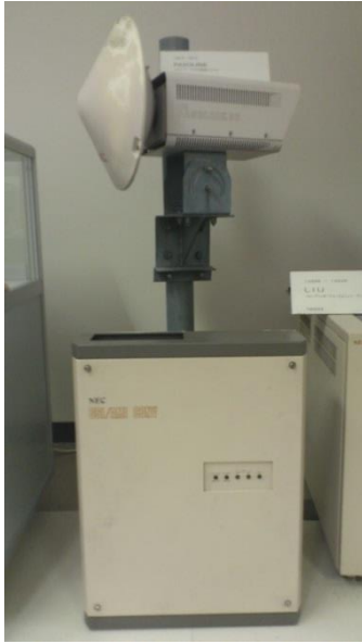
写真6 ミリ波無線装置アンテナ および般端装置
