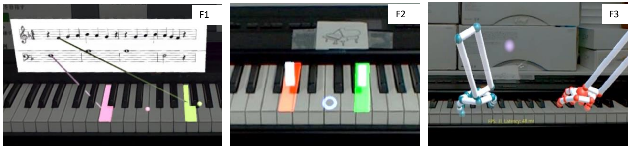
図 4.6 ピアノ演奏学習支援のためのリアルタイム AR システムの実装例
